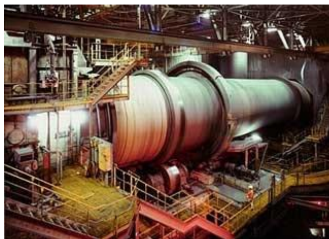
Figura 4-19. Ejemplo de horno rotativo (Interempresas.net, 2019)
