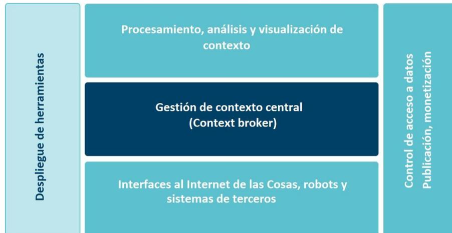
Figura 11. Estructura de la Plataforma Fiware [11].
