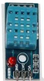
Figura 3.Sensor DHT11.
