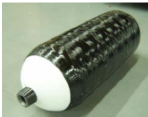
Figura 6-5. Tanque tipo II [32]
