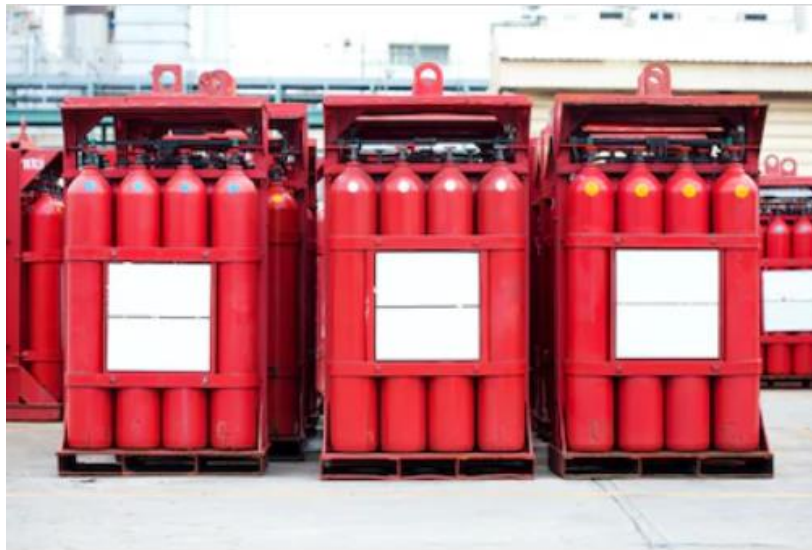
Figura 6-4. Tanques tipo I [31]
