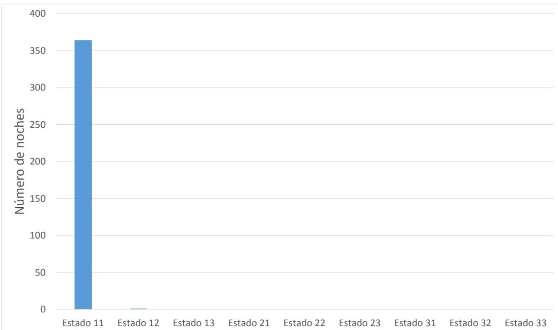
**Figura 77:** número de noches que el PCM hace una transición de un estado inicial a un estado final para una  $T_{melt}$  de 10 °C.
