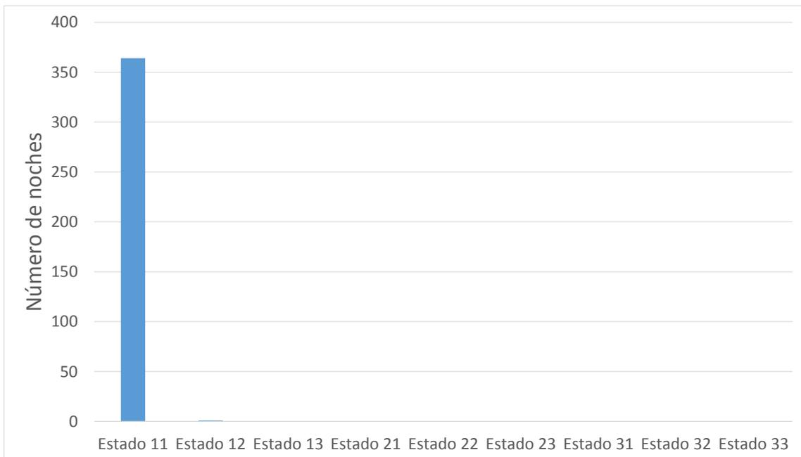
**Figura 11:** número de noches que el PCM hace una transición de un estado inicial a un estado final para una  $T_{melt}$  de 20 °C.
