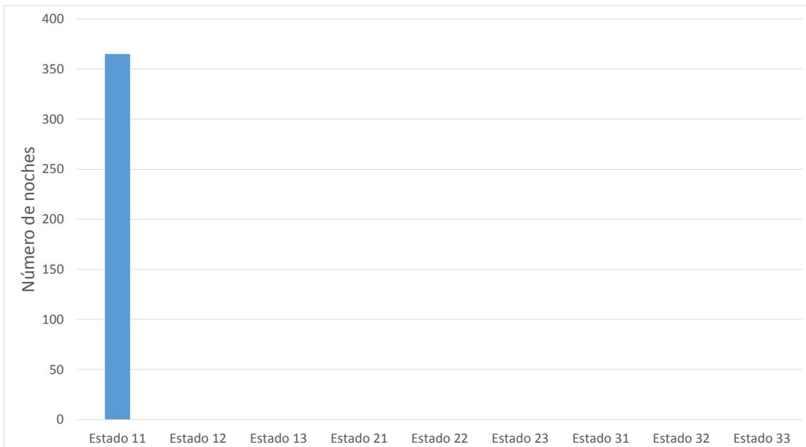
**Figura 3:** número de noches que el PCM hace una transición de un estado inicial a un estado final para una  $T_{melt}$  de 10 °C.
