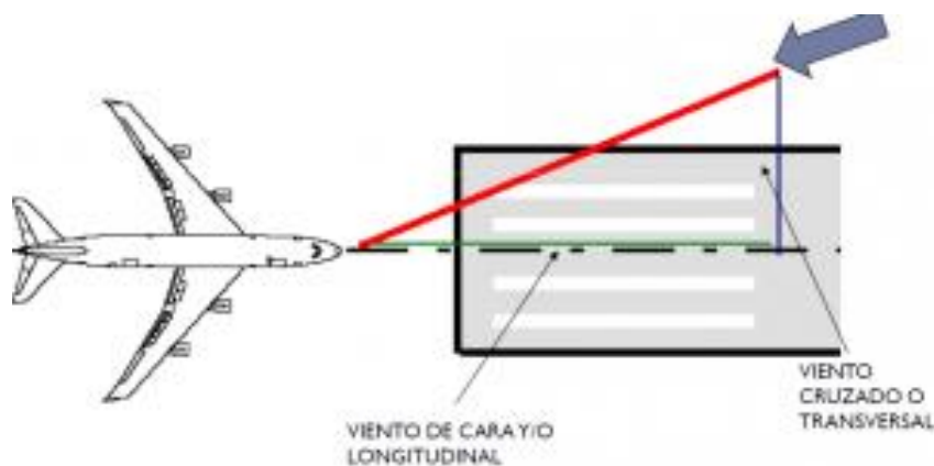
Figura 2-1. Esquema del viento en la pista de un aeropuerto [5].
