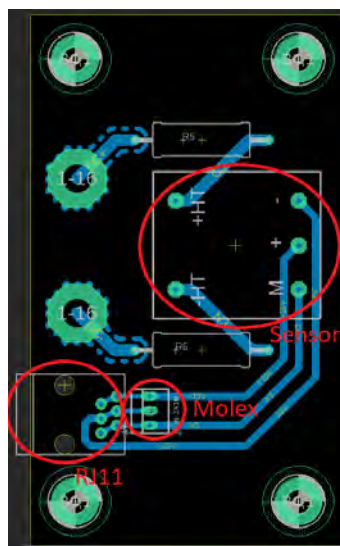
Figura 4-13 Principales elementos señalados del sensor de voltaje
