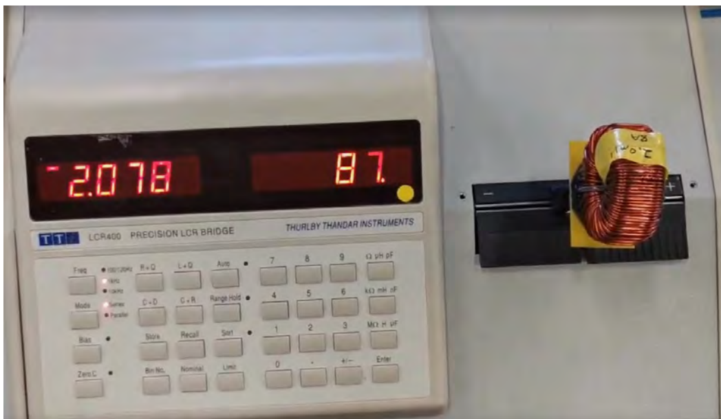
Figura 3-5 Medición de la bobina.
