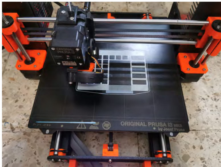
Figura 6-3 Impresora en proceso de imprimir la caja para las medidas
