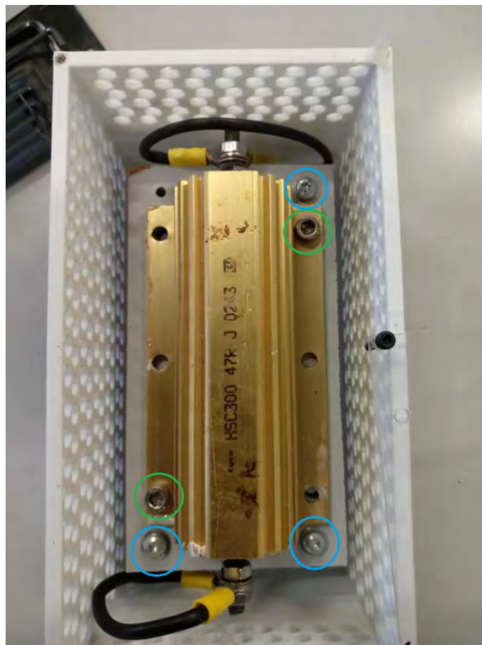
Figura 6-34 Vista en planta del bloque de la resistencia ya finalizado
