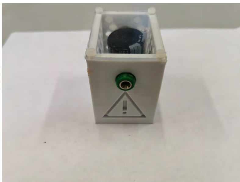
Figura 6-22 Bloque de condensador finalizado, vista lateral
