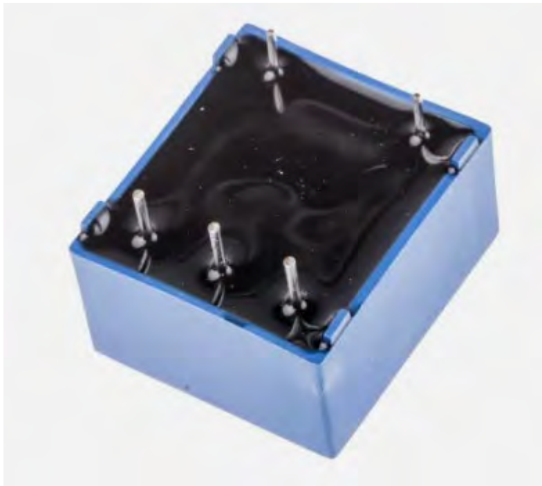
Figura 3-13 Sensor de Voltaje, parte inferior
