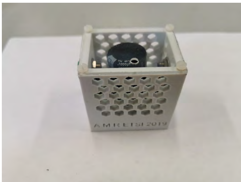
Figura 6-21 Bloque de condensador finalizado, vista frontal
