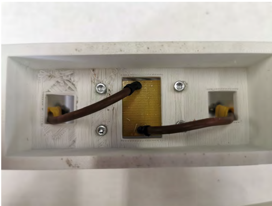
Figura 6-20. Bloque de bobina terminado, vista inferior de la sujeción
