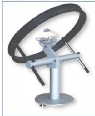
Figura 8 - Piranómetro de radiación difusa con banda de ocultación solar
