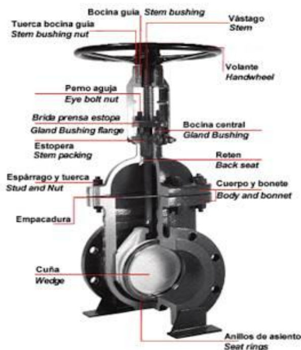
Figura 34. Estructura de una válvula de compuerta (Valvias, 2013)
