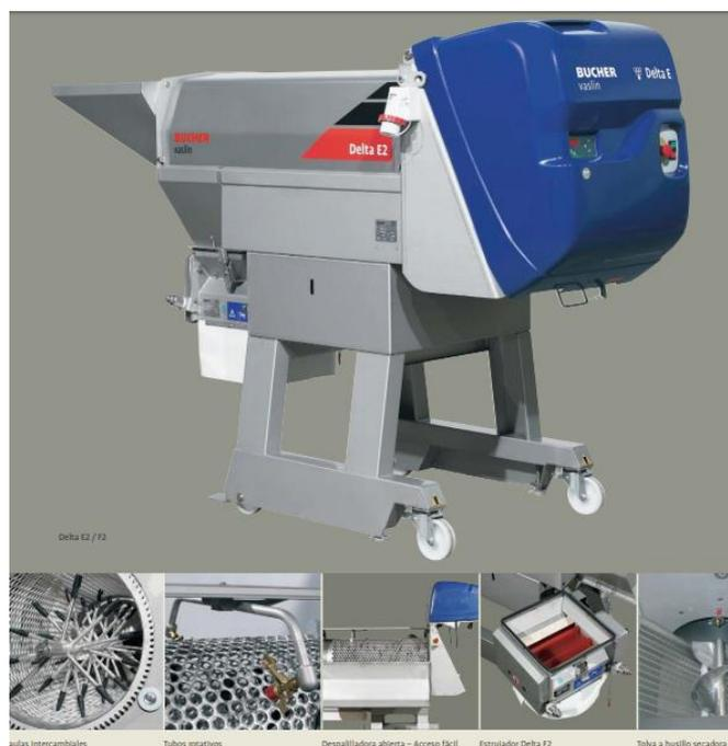
Figura 49. Despalilladora-estrujadora de la gama Delta E2 más elementos internos
