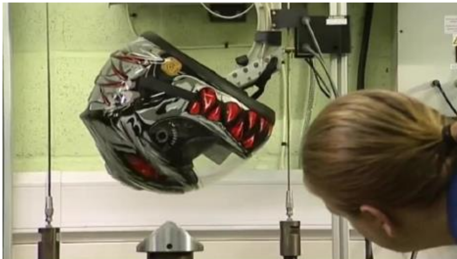
Figura 32. Prueba Resistencia Mecánica en Cuña [Fuente: Inducascos 2012]
