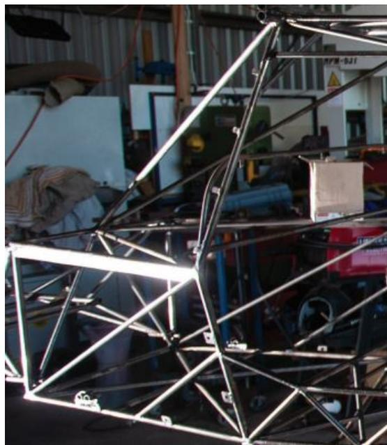
Ilustración 9 Fuselaje de tubos con fabricación actual I [3]
