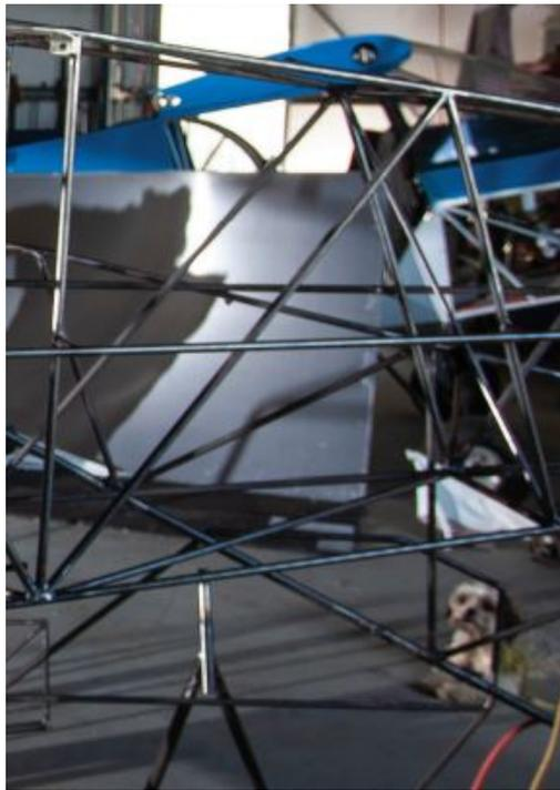
Ilustración 8 Fuselaje de tubos con fabricación actual II [3]
