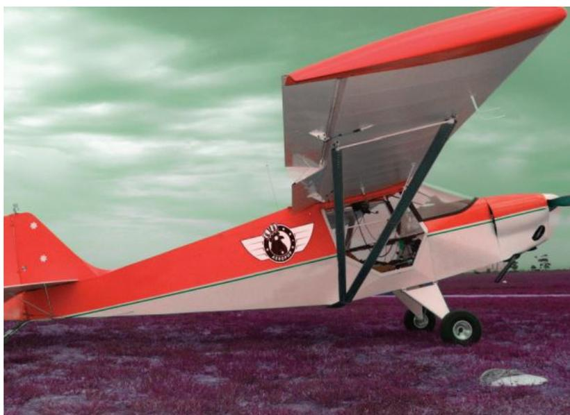
Ilustración 6 Avioneta con el tren de aterrizaje "Taildragger" [3]
