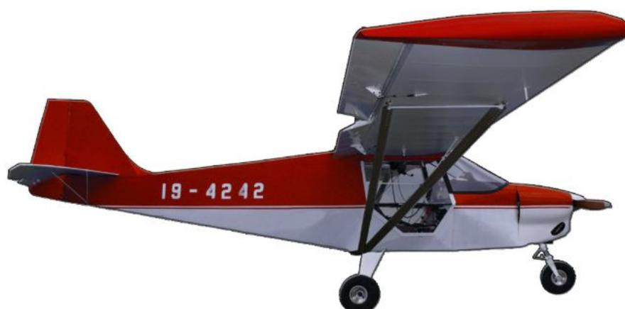
Ilustración 7 Avioneta con el tren de aterrizaje "Nose Wheel" [2]
