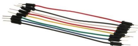
Figura 2-12: Cables Puente Macho-Macho.
