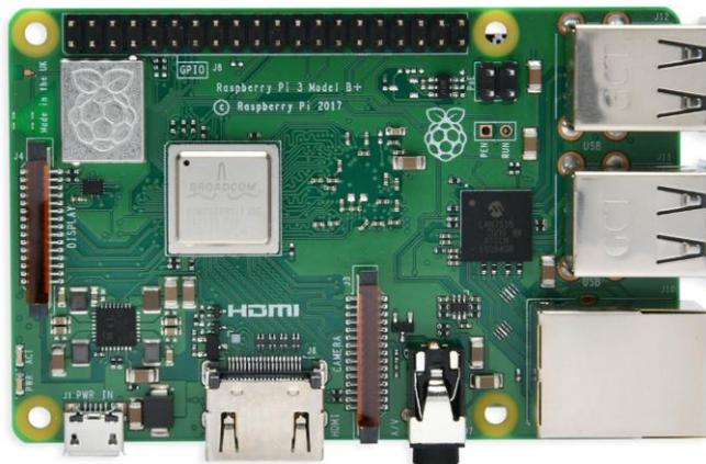
Figura 2-1: Raspberry Pi Modelo 3b+.
