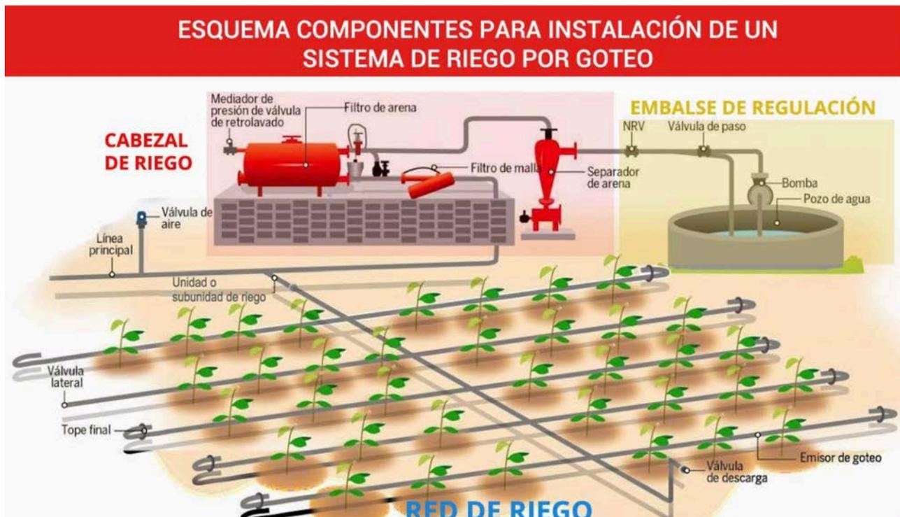
Figura 20. Esquema Sistema de Riego
