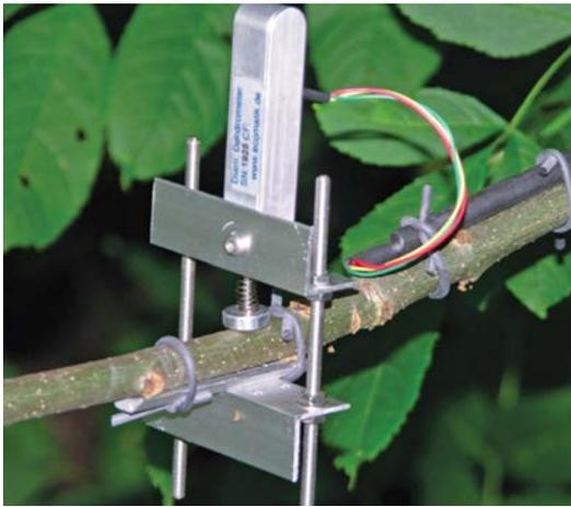
Figura 8. Dendrómetro
