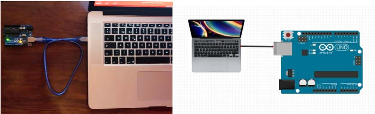
Figura 44. Conexión Módulo Arduino - Ordenador
