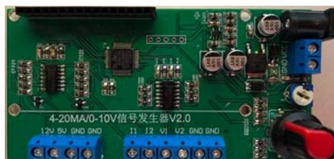
Figura 36. Generador 4-40mA/0-10V
