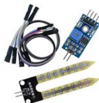
Por ejemplo: Sensores YL-69 junto con módulos adaptadores para Arduino HC-38.
