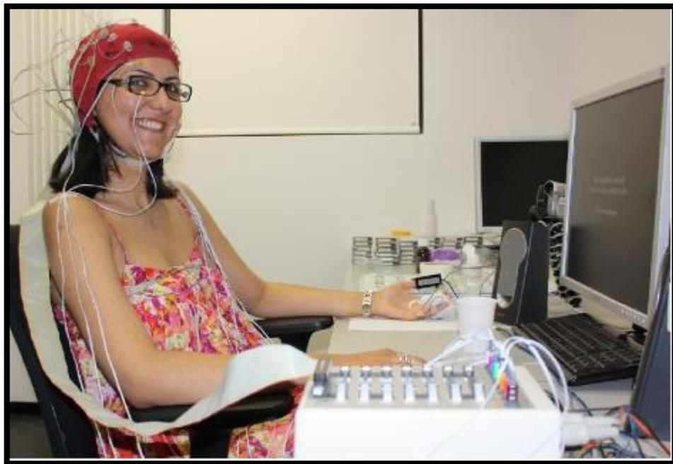
Ilustración 22: Representación gráfica de uno de los individuos que formaron parte de la recopilación de datos para la base de datos 'DEAP', podemos apreciar la colocación del casco de electrodos en malla [31].
