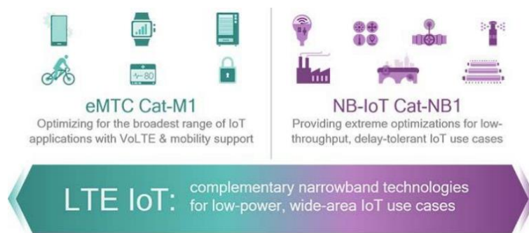
Figura 3.12. LTE para aplicaciones IoT en redes LPWAN [16].
