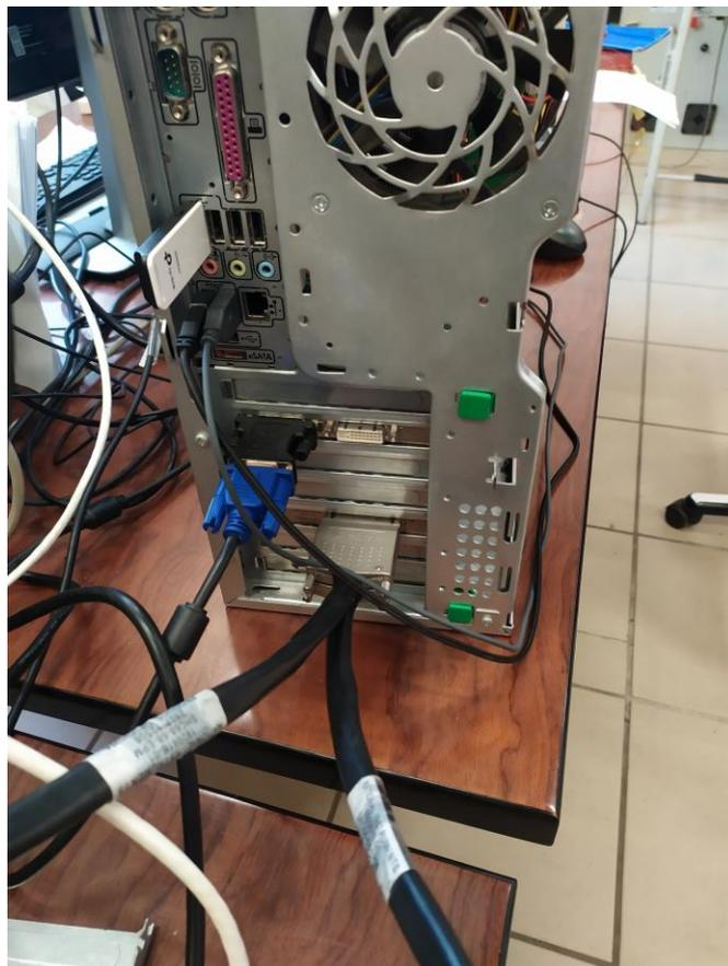
Figura 3-9. Conexión en la torre
