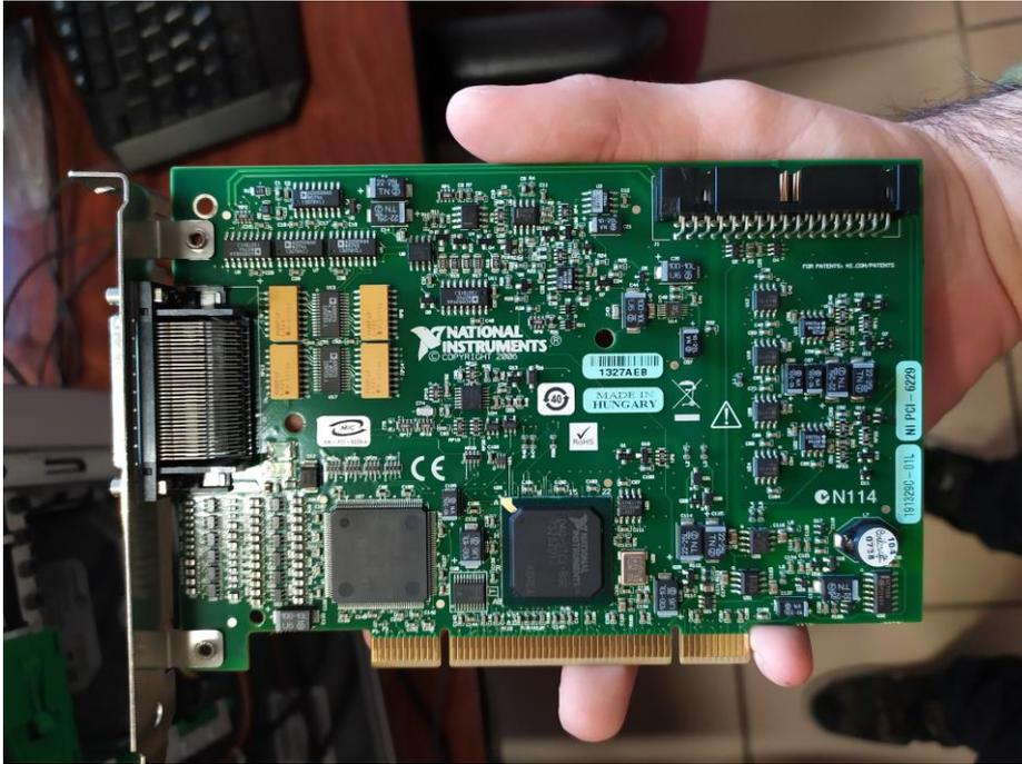
Figura 3-6. Tarjeta PCI-6229
