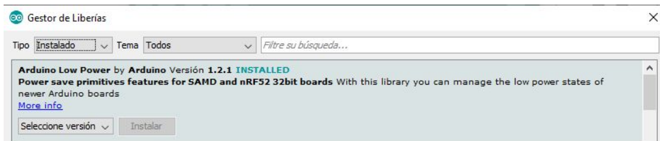
Figura 50. Instalación de librería Arduino Low Power
