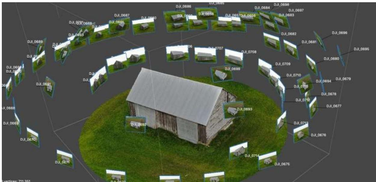
Figura 1-2. Ejemplo de proceso fotogramétrico
