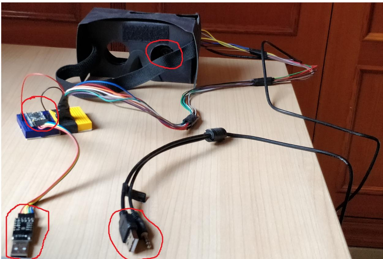
Figura 4-18. Sensor Electrooculograma y Arduino Pro Mini con conexiones.
