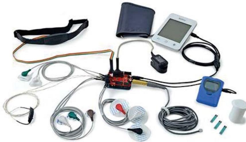
Figura 1-3. Ejemplo de dispositivos de captura de señales fisiológicas [7].
