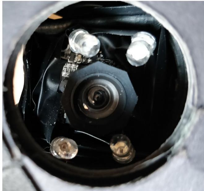
Figura 4-17. Webcam sin filtro de infrarrojos rodeada de cuatro leds infrarrojos.
