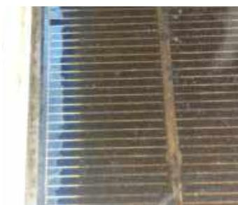
Figura 98: Detalle de delaminación exterior en el módulo 500
