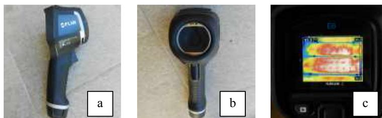
Figura 24: Material utilizado en el ensayo de termografía. a-Vista lateral cámara termográfica, b-Vista frontal cámara termográfica, c- Pantalla de la cámara termográfica
