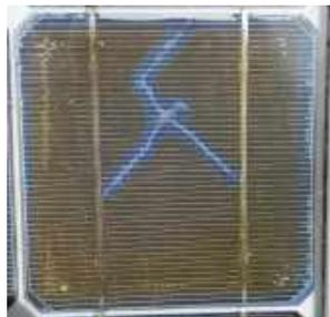
Figura 4: Ejemplo de agrietamiento de una célula sin cruzar el bus de conexiones
