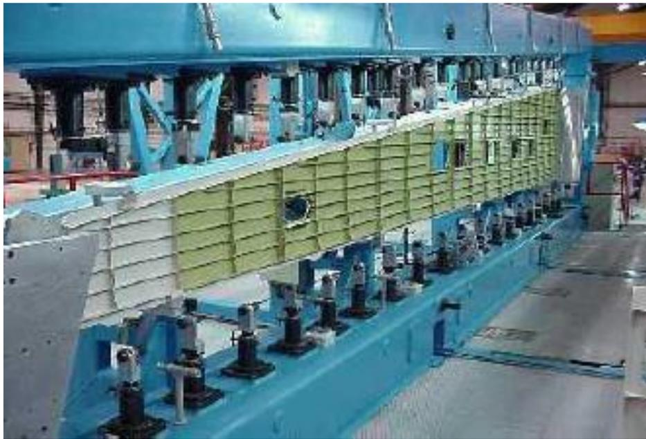
Figura 4.29 Bottom panel montado sobre las estructuras retráctiles de la fase 1 [11]
