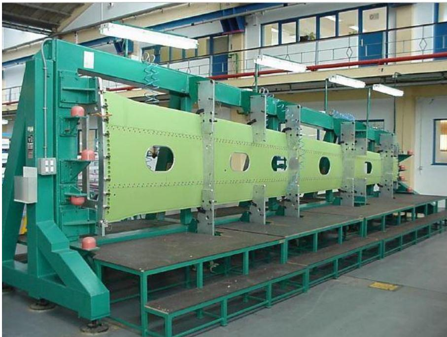
Figura 4.44 Ejemplo real de revestimiento posicionado con costillas [11]
