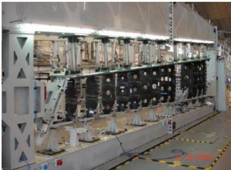
Figura 4.12 Estación de ensamblaje del cajón lateral del HTP del A400M [11]
