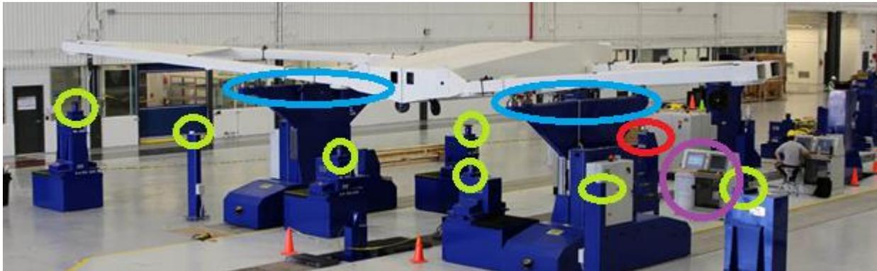
Figura 2.3 Ejemplo de integración con posicionadores y laser tracker [15]
