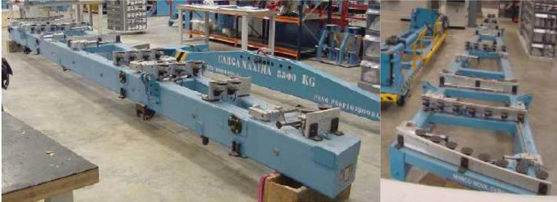
Figura 4.27 Marco universal real para el movimiento del cajón [11]
