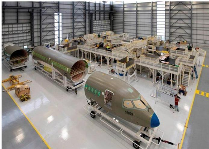
Figura 3.6 Señalización de layout en FAL del A220 en Alabama [18]
