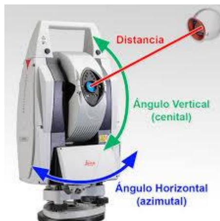
Figura 2.4 Haz de luz entre láser y espejo y movimientos del láser [16]
