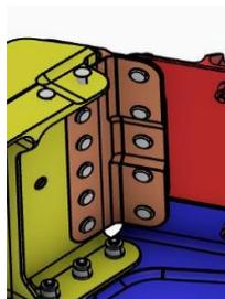
Figura 4.55 Detalle de la unión entre Wingtip, revestimiento y Front Spar
