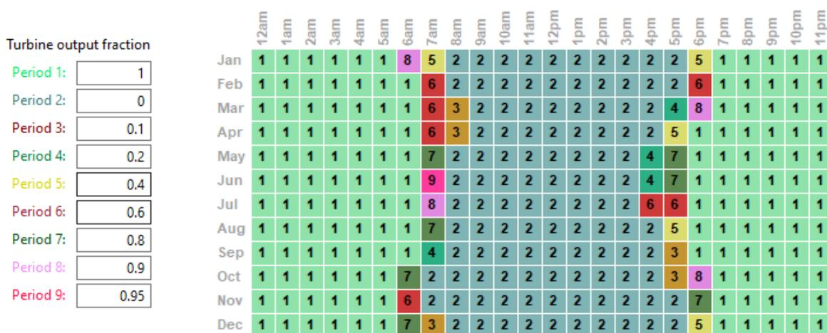
Figura 6-15: Gestión de descarga de energía térmica en la turbina establecida.
