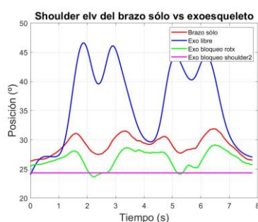
Figura 4-23. Elev. lateral del brazo sólo vs exoesq.
