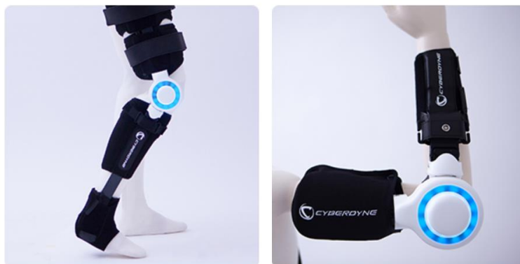
Figura 1-5. Exoesqueletos activos creados por Cyberdyne. [7]
