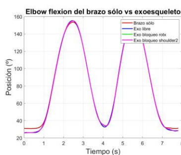
Figura 4-24. Flexión del codo del brazo sólo vs exoesq.
