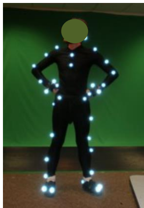
Figura 2-2. Captación de movimiento por cámaras infrarrojas y marcadores reflectantes. [16]
