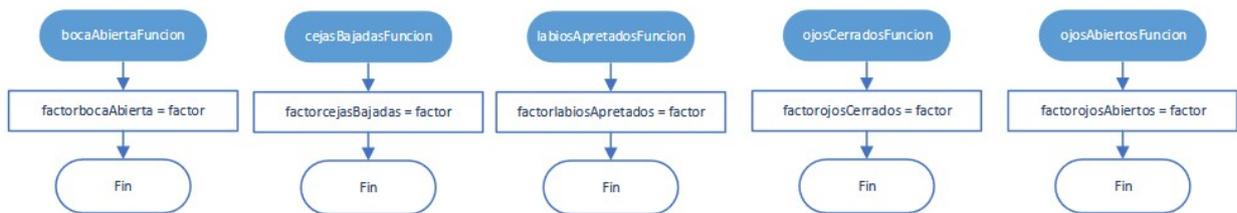
Figura 37 Diagramas de flujo de las funciones que modifican el factor de una expresión
