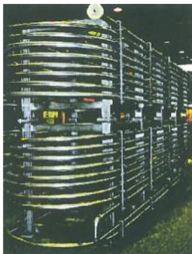
Figura 9. Vista exterior de un reactor tubular [9]
