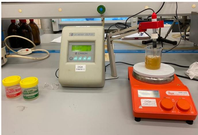
Figura 3-5: pHmetro realizando medición
