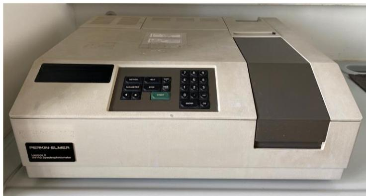
Figura 3-13: Espectrofotómetro UV-VIS
