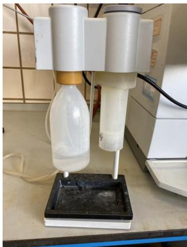
Figura 3-11: Generador de hidruros
