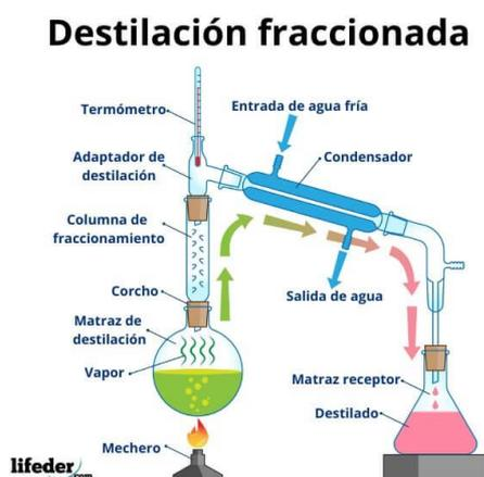
Figura 3-2: Montaje destilación (25)
