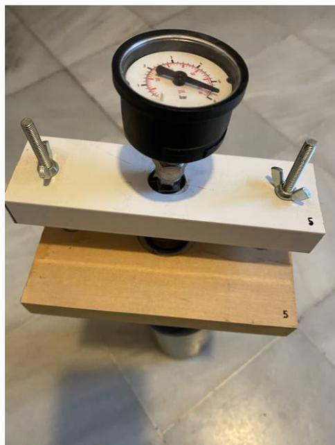
Figura 3-19: Dispositivo para control de carbonatación
