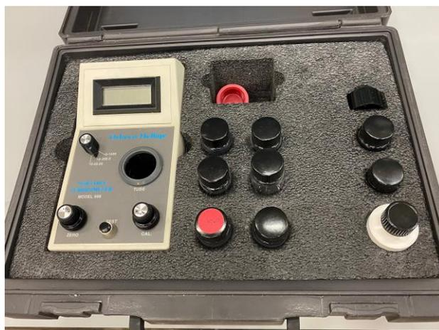
Figura 3-8: Equipo Turbidímetro
