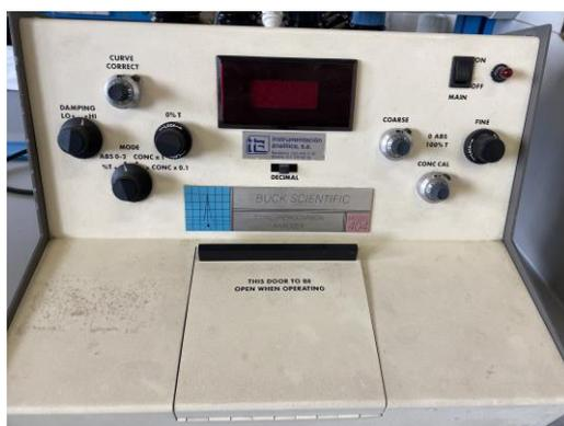
Figura 3-16: Espectrofotómetro para grasas y aceites
