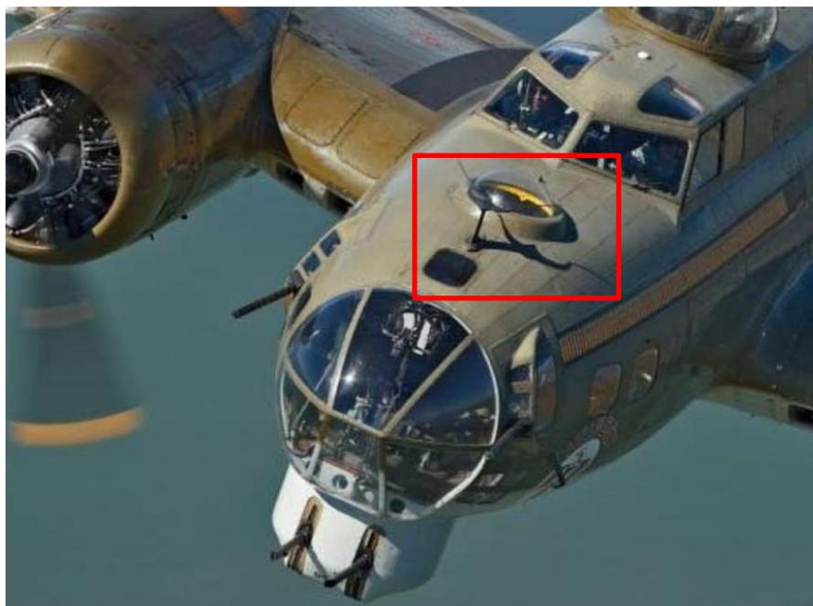
**Figura 4-160.** Imagen real de la cúpula de cristal
