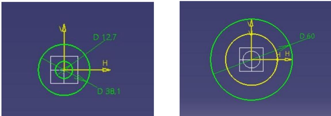
Figura 4-81. Sketch calibre cañón y carcasa
