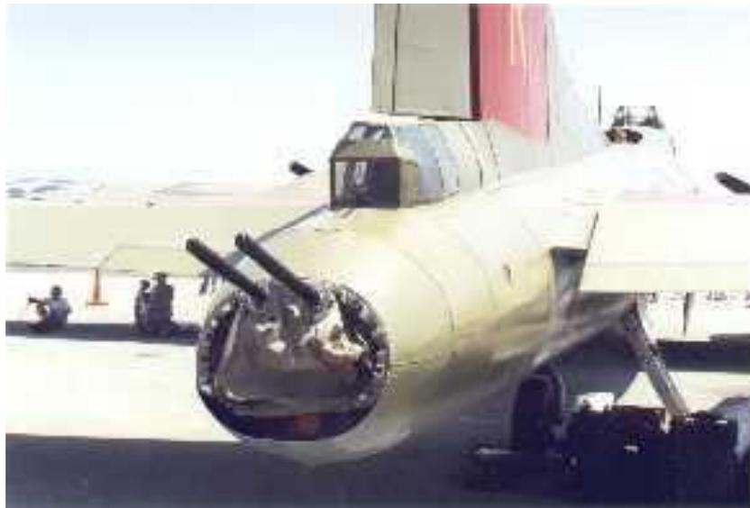
**Figura 4-87.** Imagen real del puesto de artillería de cola
