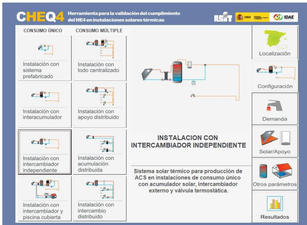
Figura 3: Pantalla Configuración CHEQ4.
