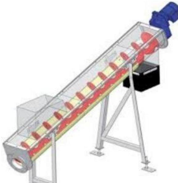
Figura 6-16. Transportador de tornillo sin fin.
