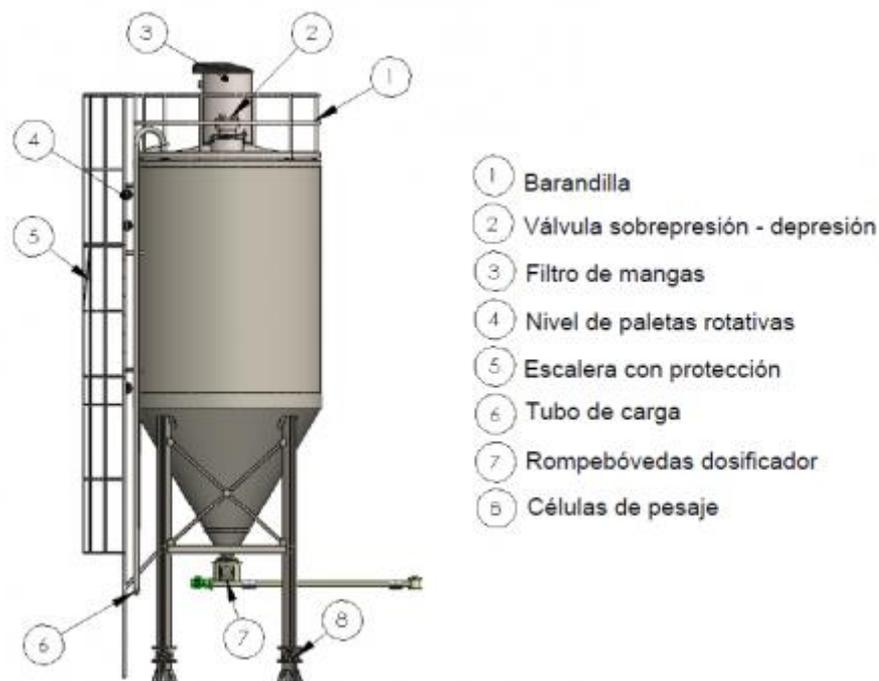
Figura 6-14. Partes de un silo industrial.
