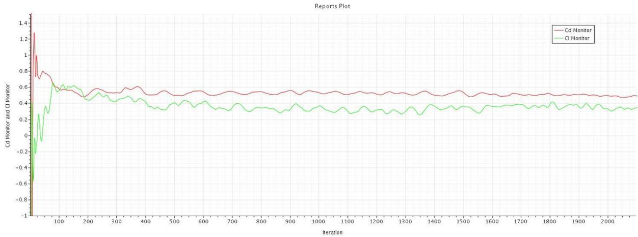
Figura 50. Evolución de los coeficientes de resistencia (rojo) y sustentación (verde).
