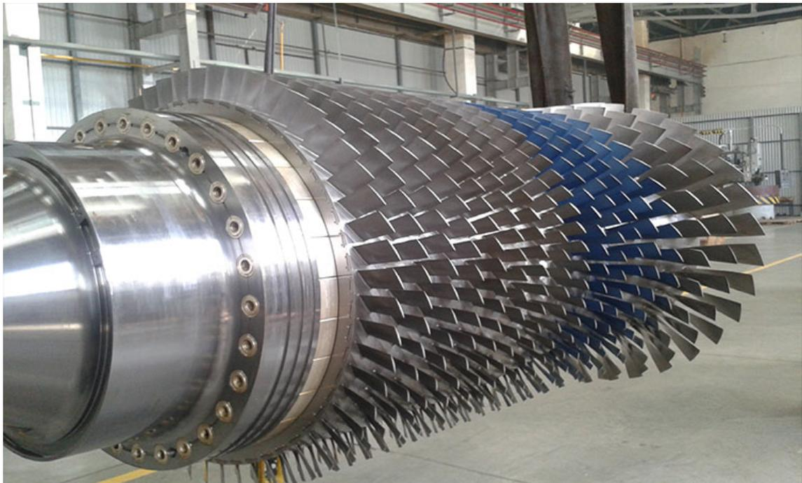
**Figura 2.8** Compresor axial.
