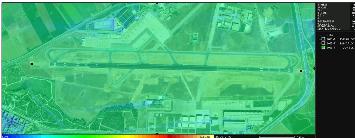
Figura 4-41. Representación más ampliada, en HTZ Communications, de la cobertura del VOR de SVL.
