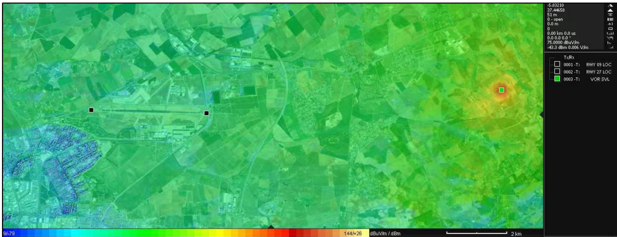
Figura 4-40. Segunda representación, en HTZ Communications, de la cobertura del VOR de SVL.
