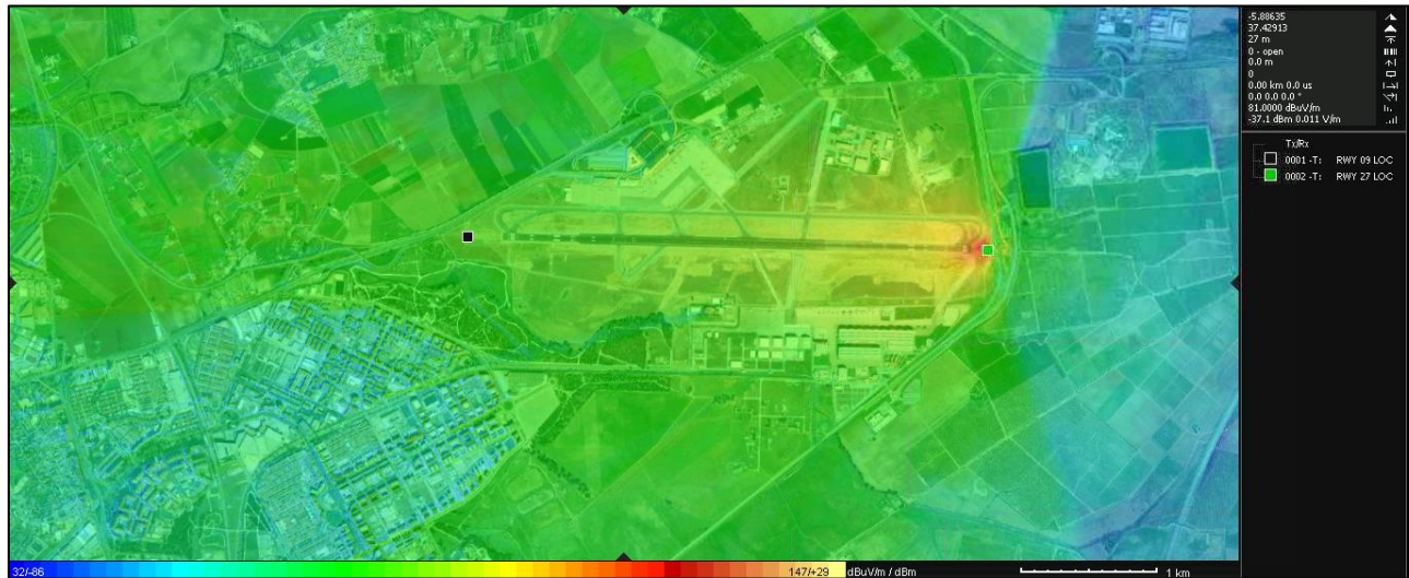
Figura 4-20. Representación general, en HTZ Communications, de la cobertura del localizador del ILS de la pista 27.
