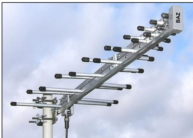
Figura 3-10. Antena log-periódicas de tipo LPDA [36].
