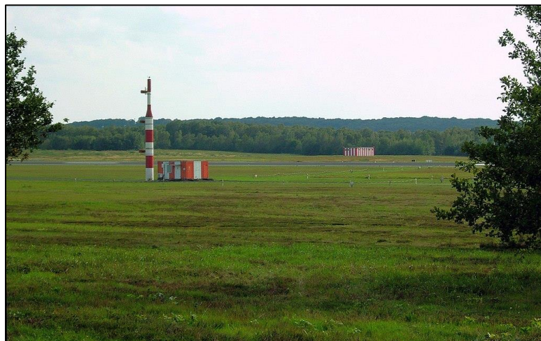
Figura 2-3. Imagen real de la antena correspondiente al Glide Slope [38].
