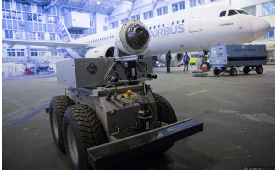
Ilustración 24 – Air-Cobot robot de inspección de Airbus
