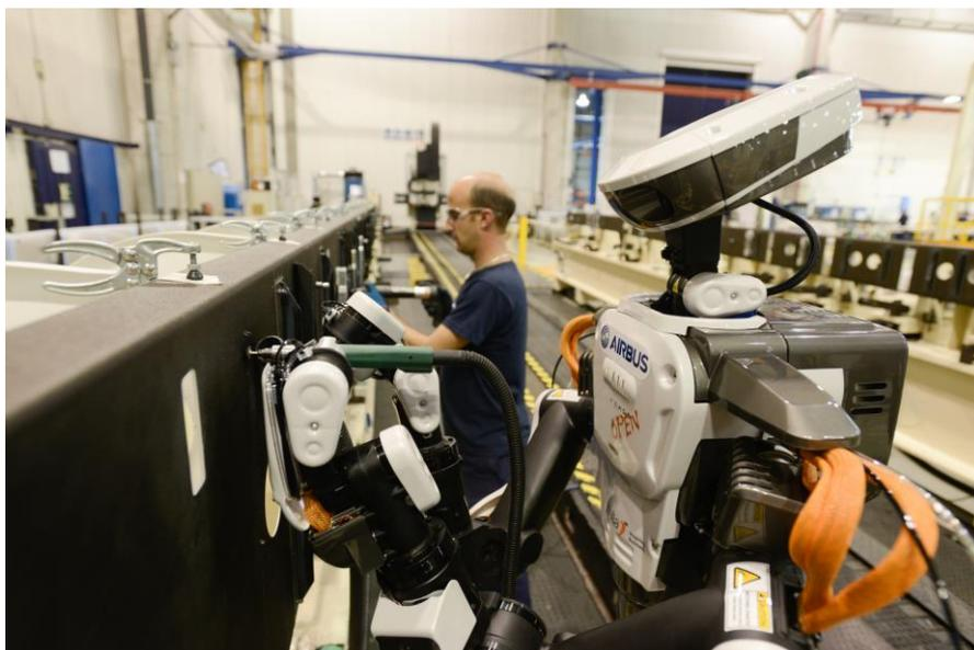
Ilustración 26 – Futurassy robot operando en las gradas de montaje de Airbus
