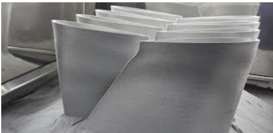
Ilustración 20 – Componentes de turbina fabricados con aditiva
