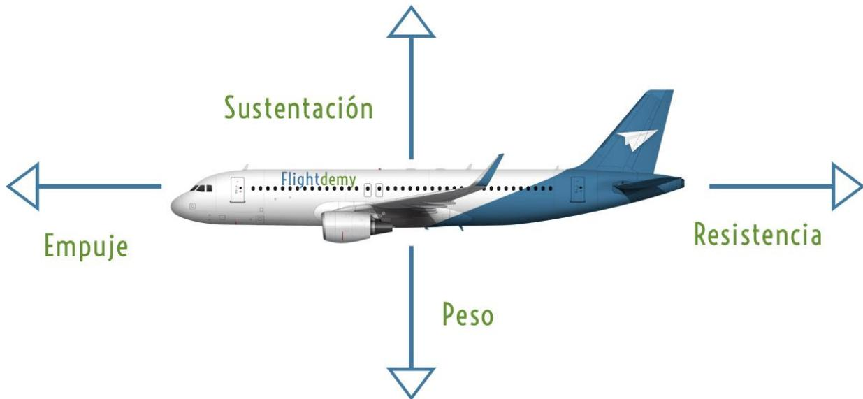
Ilustración 10 – Fuerzas que intervienen en el vuelo de un avión
