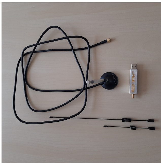
Figura 4.1 Hardware utilizado para el prototipo (Nooelec NESDR Smartee XTR).
