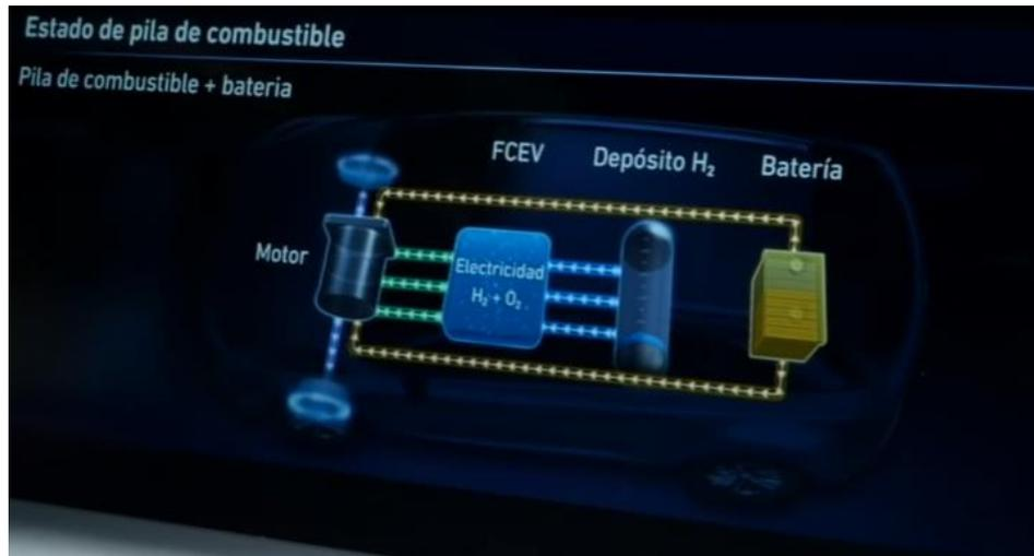
Ilustración 17: Funcionamiento batería + pila de combustible Hyundai Nexa [34].
