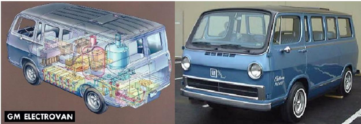
*Ilustración 1: Primera furgoneta propulsada por una pila de combustible de hidrógeno con un electrolito alcalino [7].*
