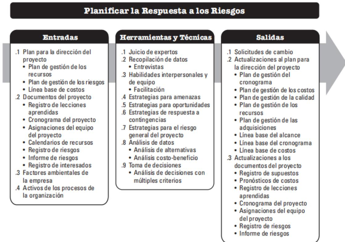
Figura 22. Entradas, herramientas y salidas del proceso planificar la respuesta a los riesgos
