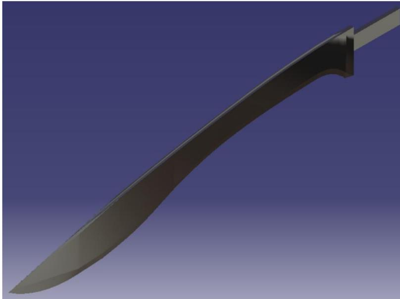
**Figura 53:** Perspectiva isométrica del modelo de la hoja 10. Elaboración propia en CATIA V5R21.
