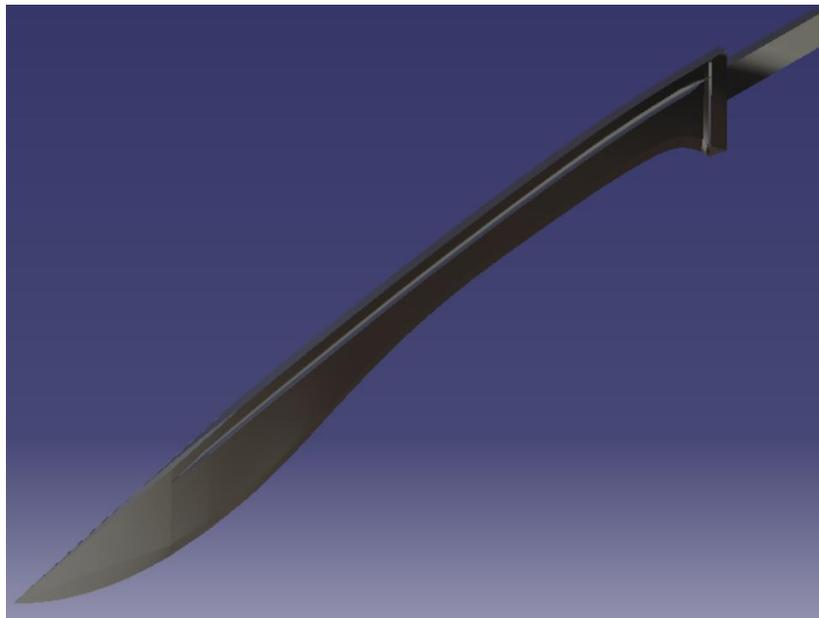
**Figura 50:** Perspectiva isométrica del modelo de la hoja 9. Elaboración propia en CATIA V5R21.
