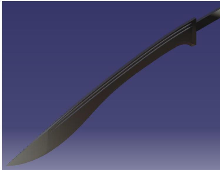
**Figura 38:** Perspectiva isométrica del modelo de la hoja 5. Elaboración propia en CATIA V5R21.
