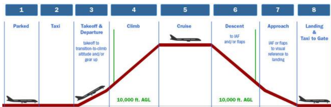
Figura 5. Fases de vuelo típica de una aeronave.
