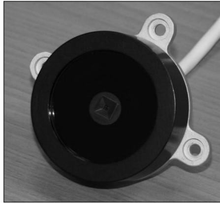
**Figura 1.1** Sensor solar analógico ISS-AX de Solar MEMS Technologies [4].
