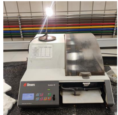
Figura 3.14 Máquina de corte de precisión Struers.
