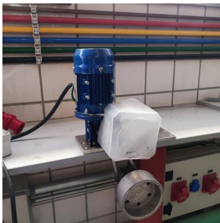
Figura 3.18 Dispositivo para hacer rotar el molino de bolas.
