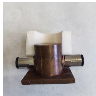
Figura 3.3 Molde cilíndrico para la muestra con una base de cobre.
