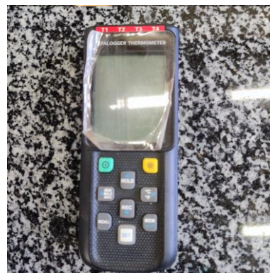
Figura 3.5 Termómetro de cuatro canales con almacenamiento de datos HH-521BT.
