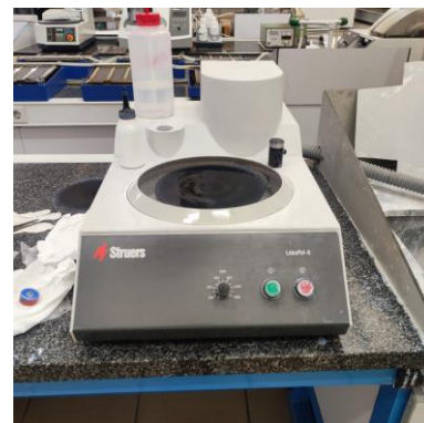
Figura 3.11 Pulidora de disco Struers Labopol-6.
