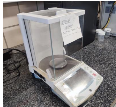
Figura 3.15 Balanza de precisión Ohaus Explorer Pro.
