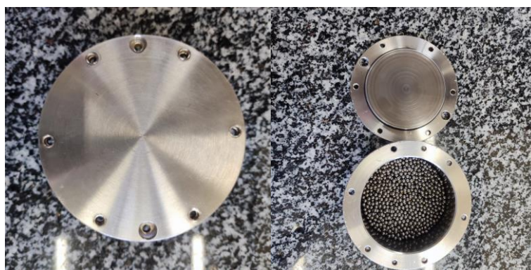
Figura 3.17 Molino de bolas (a) cerrado (b) abierto.
