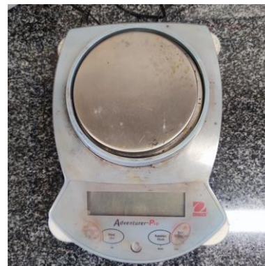
Figura 3.9 Balanza de precisión Ohaus AV212.
