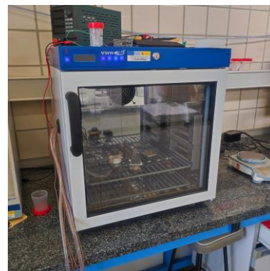
Figura 3.2 Incubadora de laboratorio INCU-Line IL.
