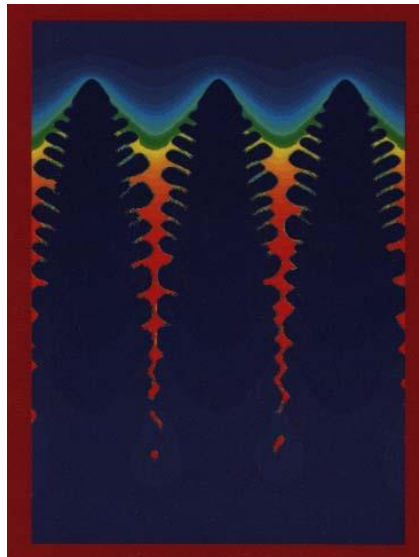
Figura 2.8 Crecimiento dendrítico simulado por medio de un ordenador, utilizando un método de autómatas celulares. (Dilthey et al., 1997)
