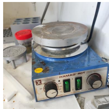
Figura 3.6 Agitador magnético con placa calefactora IKAMAG RCT.
