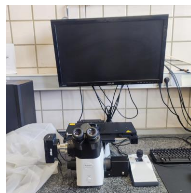
Figura 3.12 Microscopio óptico metalográfico Nikon MA100N.
