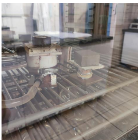
Figura 3.20 Muestra solidificando direccionalmente en el interior de la incubadora.
