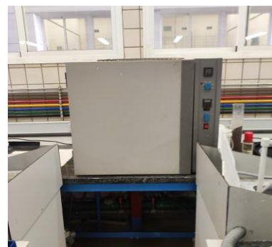
Figura 3.13 Horno tipo mufla Carbolite.
