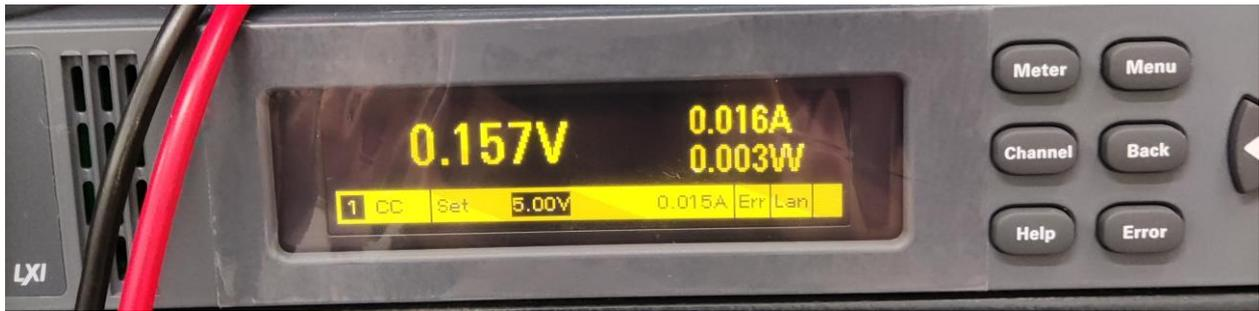
**Figura 6.3** Tensión aplicada e intensidad consumida por resistencia de 10  $\Omega$
