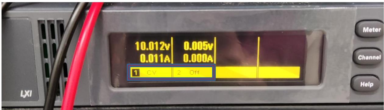
Figura 5.1 Ejemplo con el canal 1 habilitado en modo "Constant Voltage" y canal 2 deshabilitado
