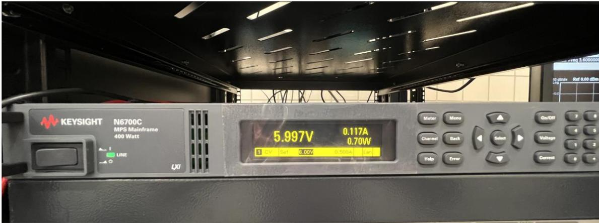
Figura 6.7 Tensión y consumo del amplificador ZX60-V62+.
