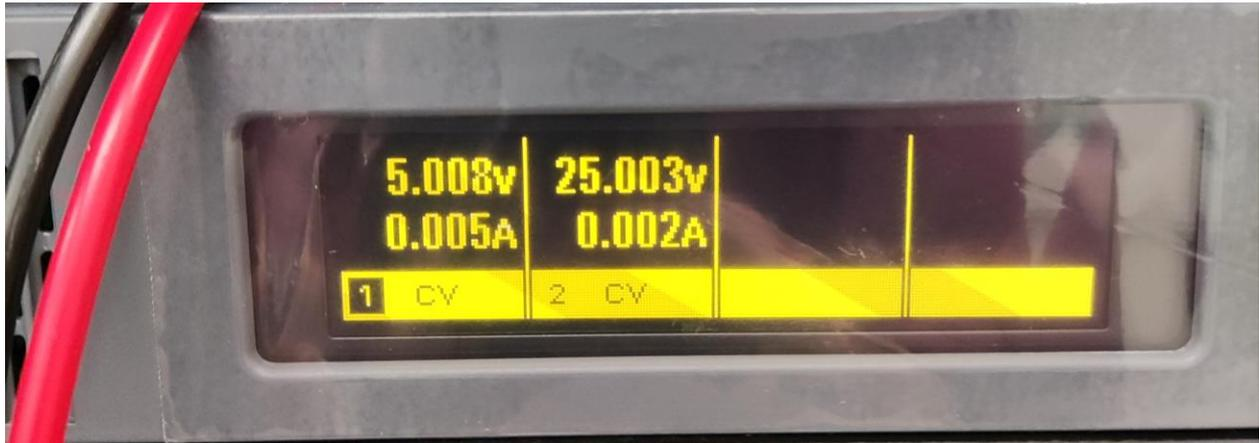
**Figura 6.4** Tensión aplicada e intensidad consumida por resistencias de 1 k $\Omega$  y 10 k $\Omega$
