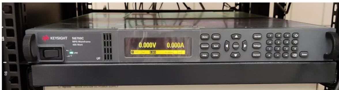
Figura 4.1 Panel frontal de la fuente de alimentación N6700C.
