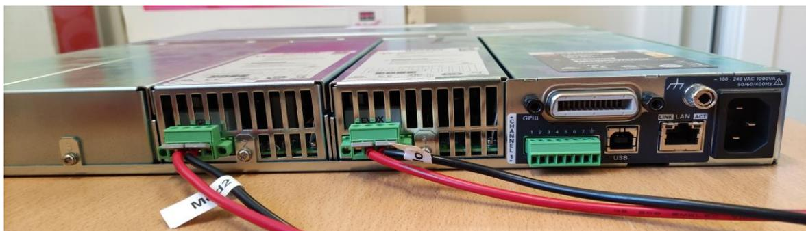
Figura 4.2 Parte trasera. Conexiones de los módulos 1 y 2.
