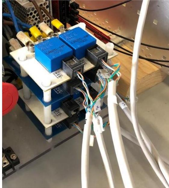
Figura 6-3. Sensores de medidas situados en el equipo.
