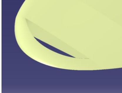
**Figura 4.41.** Superficie del borde de punta del estabilizador horizontal
