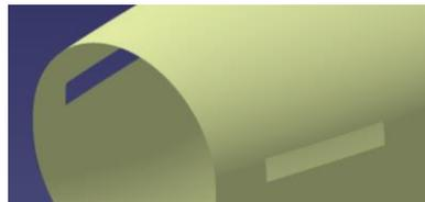
**Figura 4.96.** Cortes rectangulares en la superficie de la góndola
