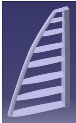
**Figura 4.48.** Estructura fija del estabilizador vertical
