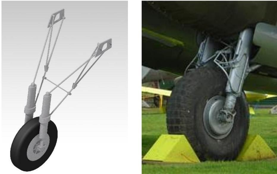
**Figura 4.125.** Tren de aterrizaje principal. A la derecha, extracción de “De Havilland DH.98 Mosquito T.43 (Nº de Serie A52-1053) conservado en el Museum of Transport and Technology de Auckland, Australia” [3]
