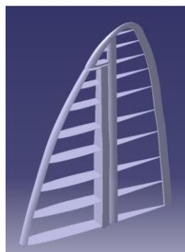
**Figura 4.52.** Estructura del estabilizador vertical
