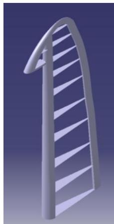
**Figura 4.51.** Estructura móvil del estabilizador vertical
