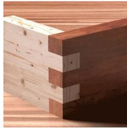
**Figura 4.119.** Ensamblaje a media madera [13]
