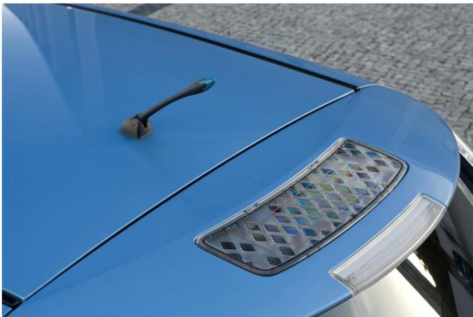
Figura 2-3. [6] Este es el panel fotovoltaico instalado en el Nissan Leaf, pensado más como un extra que como un sistema de generación de energía para la alimentación del motor y/o batería principal. Su fin es generar electricidad para mantener en funcionamiento sistemas auxiliares del vehículo, conectados a una batería de reserva de 12V que entraría en funcionamiento si la batería principal estuviera desconectada.
