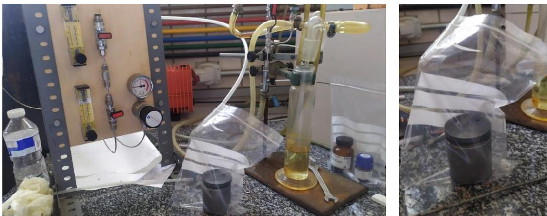
Figura 3-4: Proceso de llenado de argón en el jarro del molino
