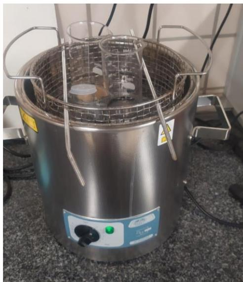
Figura 3-4: máquina de ultrasonidos dispersando los reactivos de ambas mezclas
