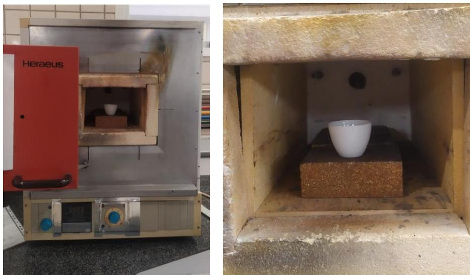
Figura 3-7: Horneado del material seco en el horno
