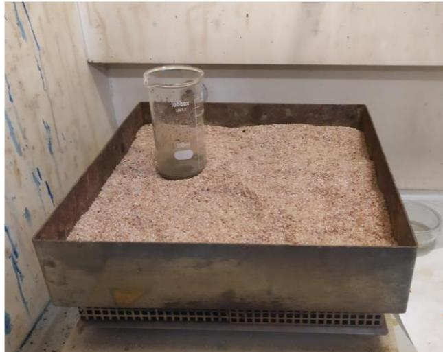
Figura 3-6: Secado de la mezcla en el dispositivo de baño de arena
