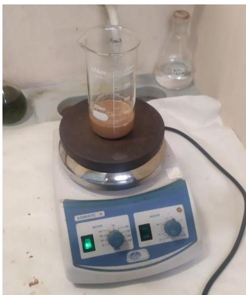
Figura 3-5: Mezclado de los componentes en el agitador magnético
