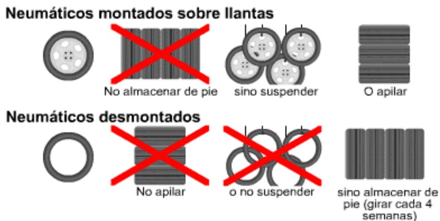
Figura 4.8: Almacenamiento de neumáticos según si están con o sin llanta. [13].
