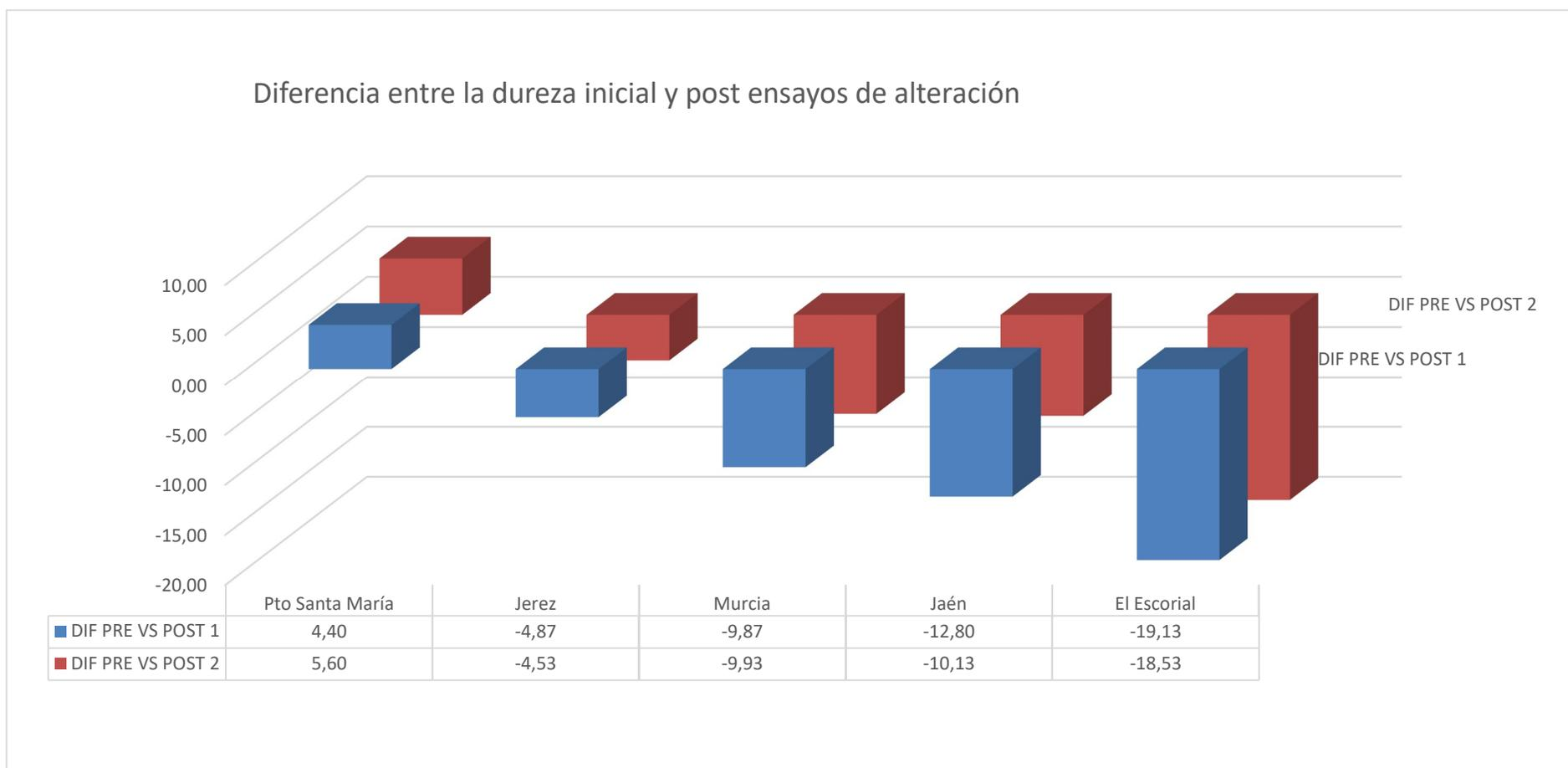
Figura 4-8. Diferencias de dureza
