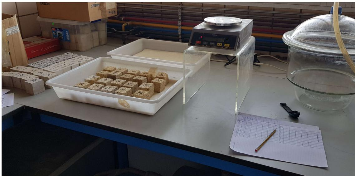
Figura 3-9. Preparación del ensayo de absorción de agua por capilaridad
