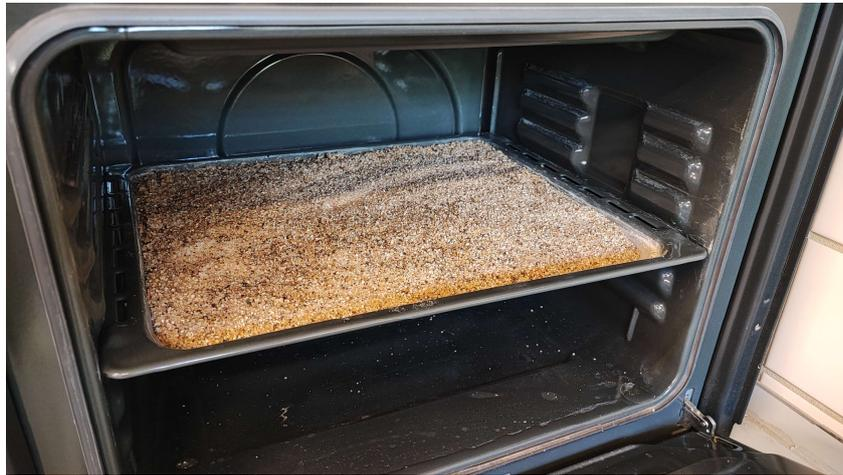
*Figura 3-16. Base de arena húmeda para el ensayo de alteración 2*
