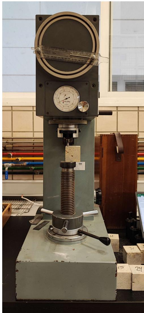
*Figura 3-7. Durómetro*
