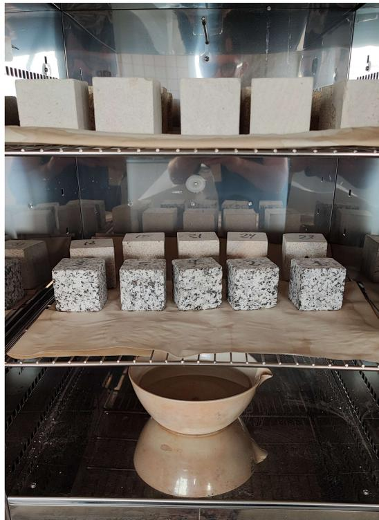
*Figura 3-15. Disposición horno ensayo alteración 1*
