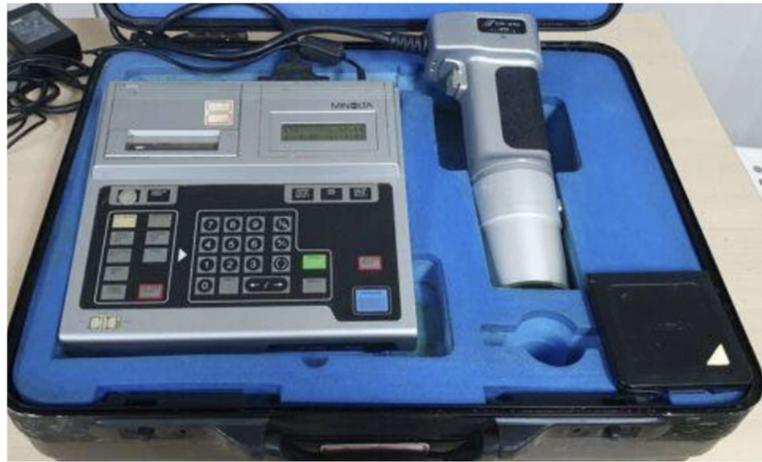
*Figura 3-5. Colorímetro Minolta*
