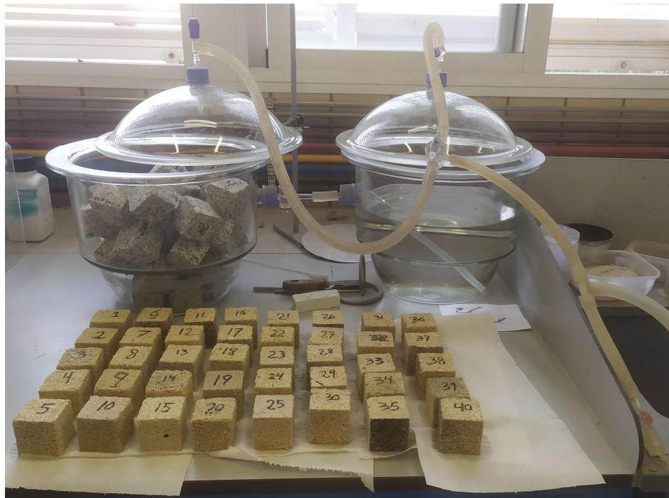
Figura 3-2. Probetas saturadas y Probetas tras periodo de vacío
