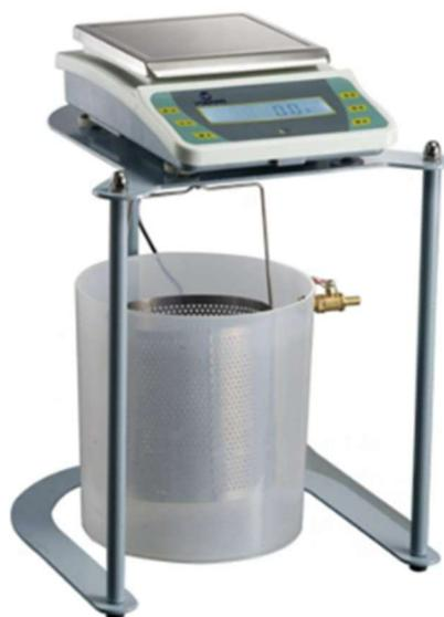
Figura 3-4. Balanza modificada para la pesada hidrostática
