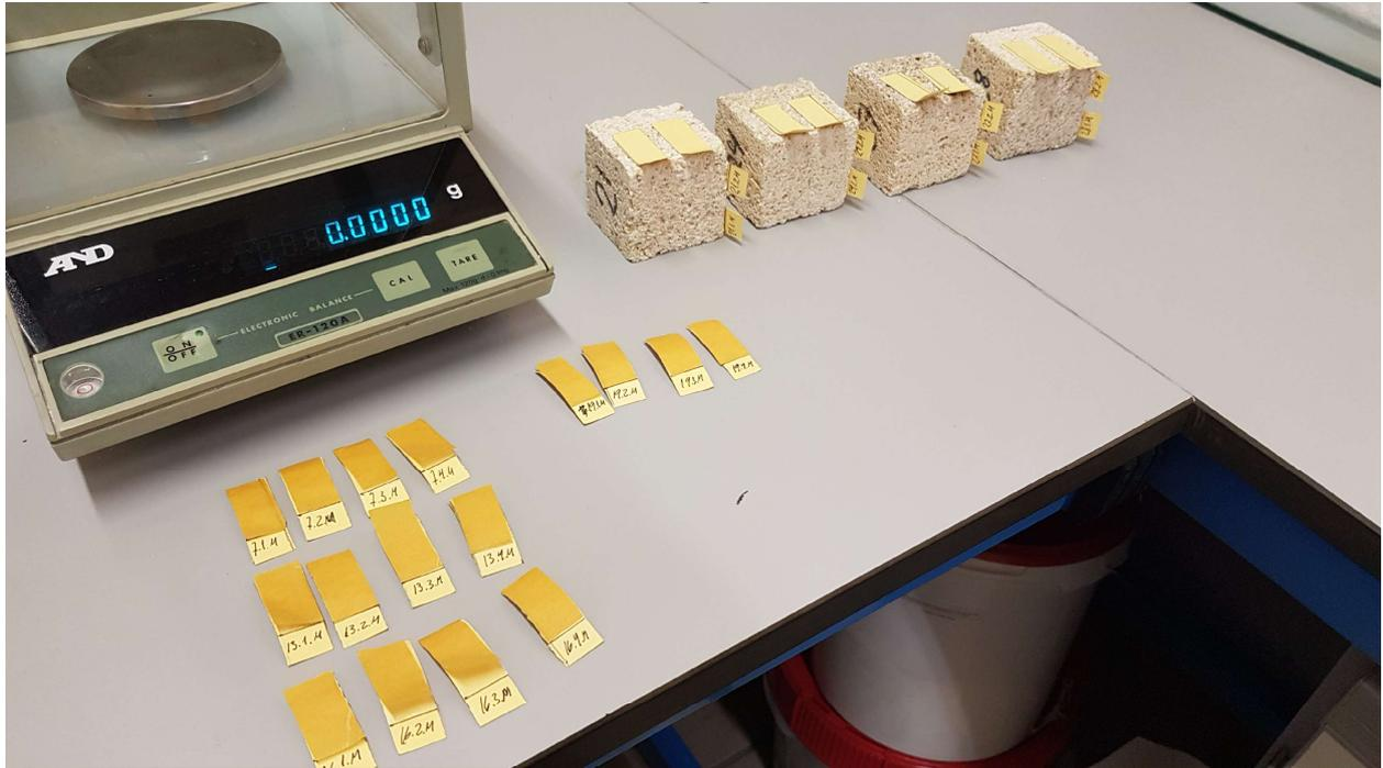
*Figura 3-12. Realización del peeling test*
