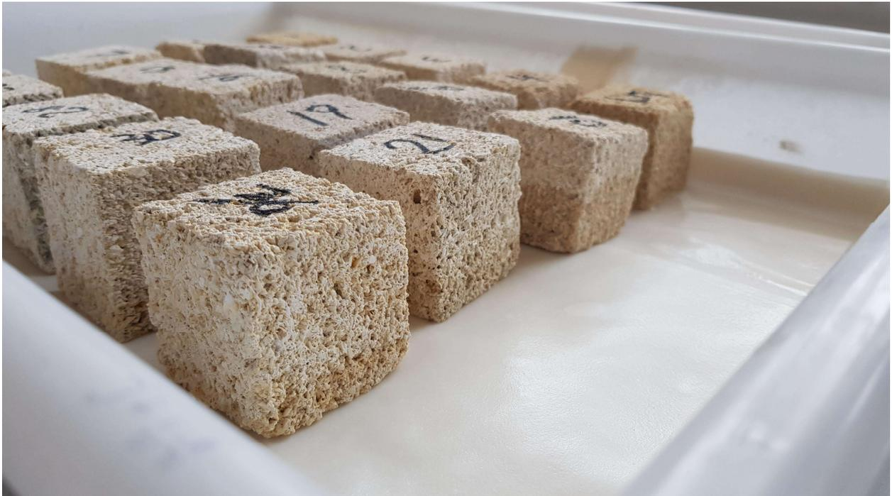
*Figura 3-10. Ensayo de absorción de agua por capilaridad*
