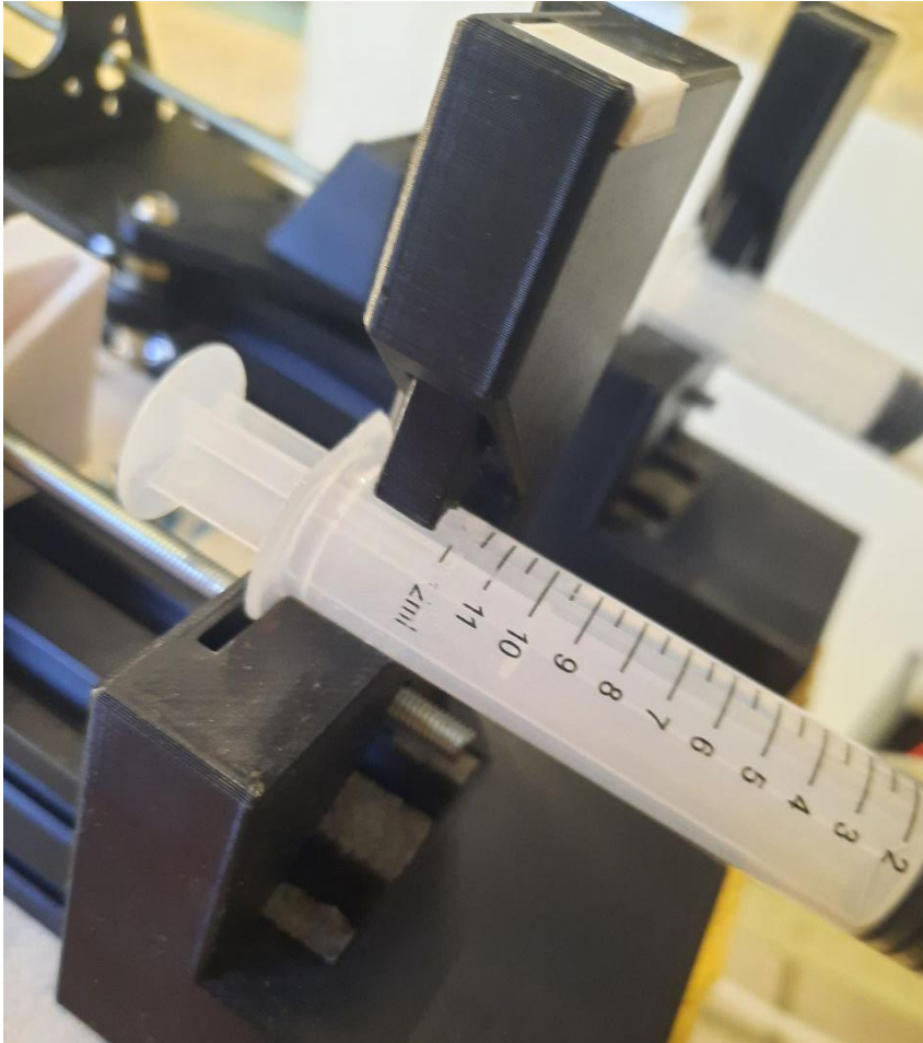
Figura 17: Detalle de sujeción de jeringa
