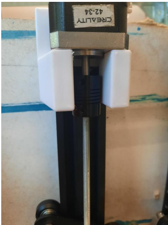
Figura 16: Detalle unión motor-tornillo
