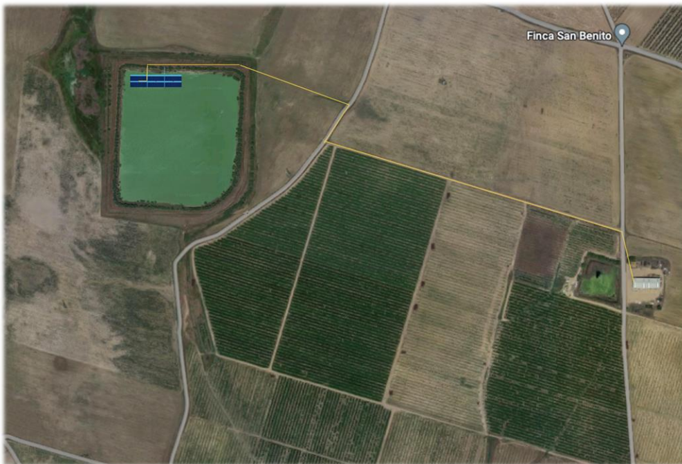
Figura 20: Cableado (amarillo) CA desde inversor más lejano hasta cuadro de BT. Producción propia
