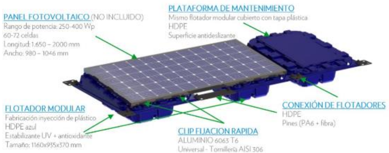
Figura 12: Esquema sistema flotador de Isifloating. [J]
