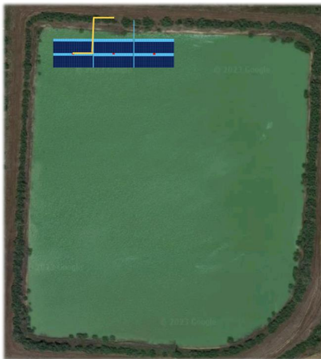
Figura 21: Cableado (amarillo) CA desde inversor más lejano hasta el nuevo cuadro de BT. Producción propia
