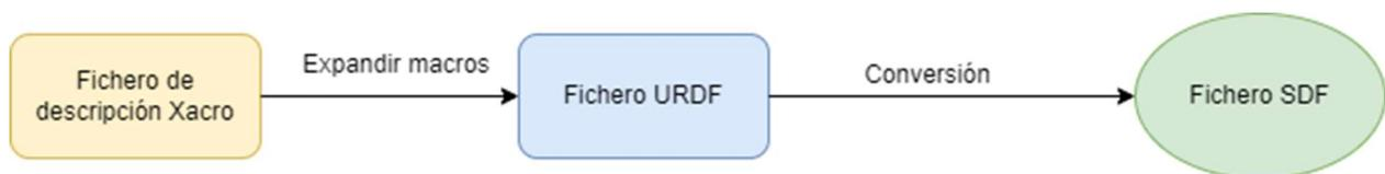
Figura 4–3 Línea de trabajo para cargar el modelo en simulador
